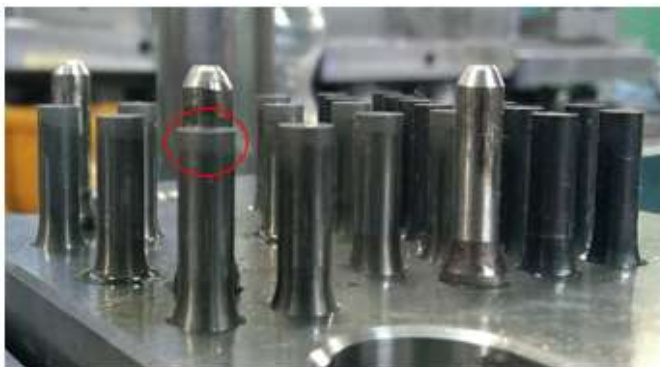
Figura 2. Punção de furação APS30 com desgaste
