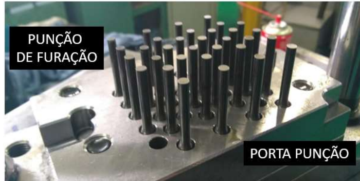
Figura 5. Punções de metal duro acoplados na porta punção da ferramenta
